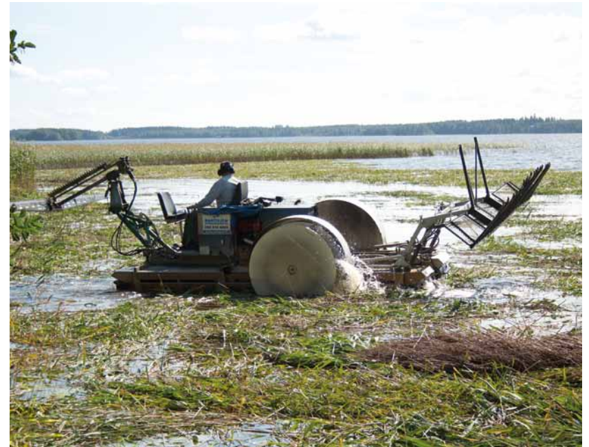
Kuva 2. Ponttoonialustainen niitto- ja keruukone, jossa edessä leikkuri ja takana keruulaite. Tässä kyseisessä koneessa on tela-alusta sekä siipirattaat.
